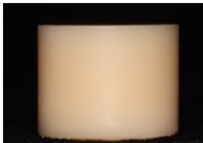
ภาพที่ 1 ชิ้นงานรูปทรงกระบอกที่ขึ้นรูปด้วยเครื่องพิมพ์แบบ 3 มิติ ขนาด 20 \times 15 มิลลิเมตร
